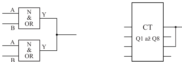
obr.b - nepřípustná zapojení
